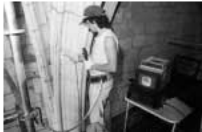
Imagen 138. Utilización de videoendoscopio en el crucero sur de la Catedral
