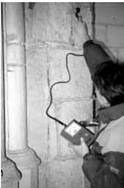
Imágenes 240 y 241. Toma de mediciones con el instrumento Acqua Boy BMI
