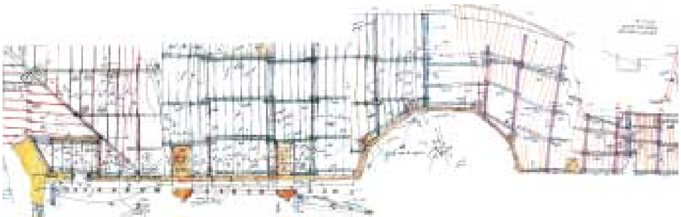
Imagen 285. Croquis de la estructura de madera de la cubierta de las capillas del brazo norte y sur del crucero y de la girola
