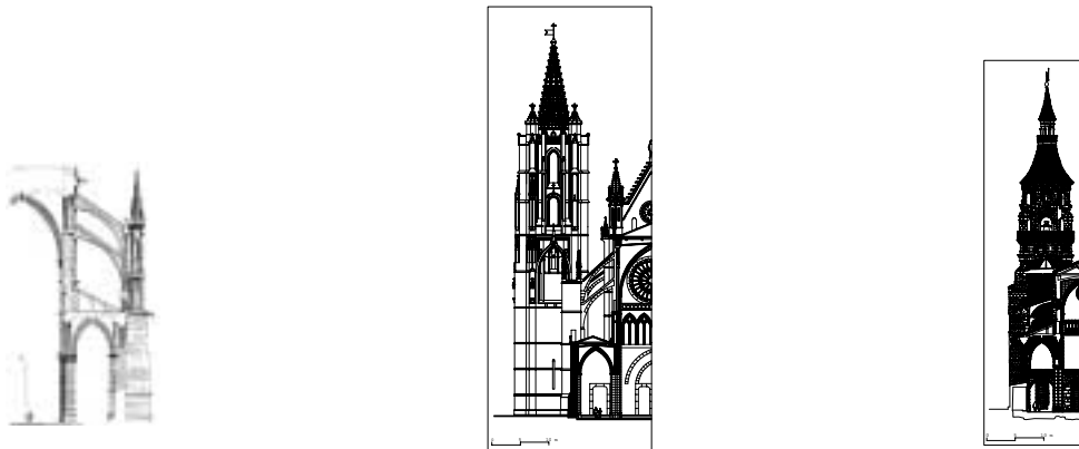
Imagen 60. Comparación a escala de las secciones transversales de las catedrales de Rheims (Viollet-Le-Duc, E. 1998), León (dibujo del Plan Director de la Catedral de León de los arquitectos Mariano Díez Sáenz de Miera y Cecilio Javier Vallejo Fernández, cedido por la Dirección General de Patrimonio Cultural de la Junta de Castilla y León) y Vitoria (dibujo del Plan Director)
