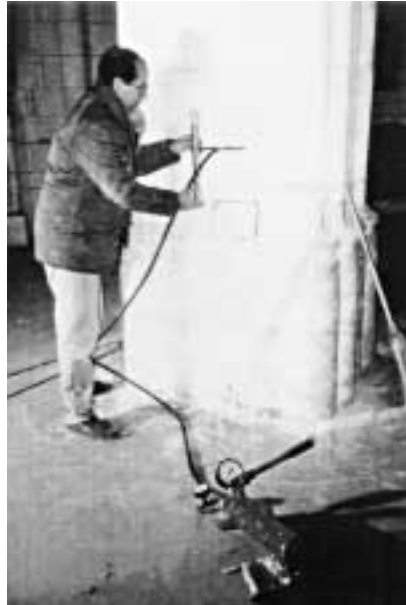
Imagen 560. Determinación del estado tensional T2
