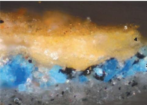
Corte estratigráfico de la secuencia de capas de color, en los plementos y muros de la Capilla de Paternina.
