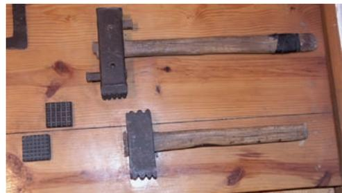
Herramientas para desbastar: boca de bujarda y bujarda de hierro fundido.
