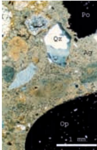
Img. 2.3. Fotomicrografía muestra 53. Junta sillar. Triforio; cierre ándito; nave norte; tramo 2. Qz: cuarzo; Op: minerales opacos; Ag: aglomerante; Po: porosidad.
