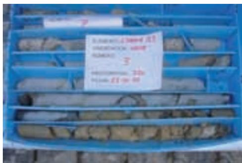
Img. 6.6. Documentación de caja con identificación de testigo recuperado.
