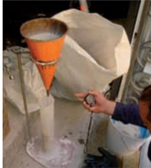
Img. 6.11. Medición de fluidez de la lechada.
