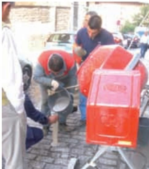
Img. 6.9. Llenado de probeta para la comprobación de fluidez.
