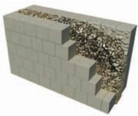
Img. 2.5. Muro con dos caras de sillería y relleno interior.
