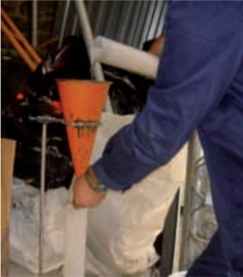
Img. 6.10. Introducción del fluido en el cono Marsh normalizado taponando la parte inferior.
