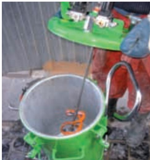
Img. 6.14. Imagen del calderín con la mejora introducida al disponer de una batidora de longitud el vaso, accionado con un taladro simple a baja revolución.
