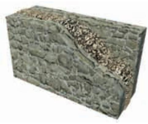
Img. 2.7. Muro con dos caras de mampostería y relleno interior.
