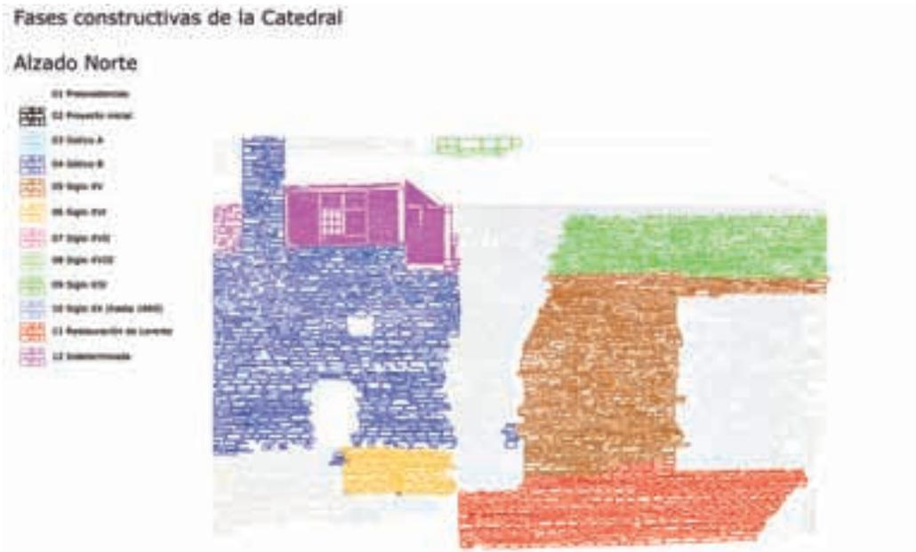
Img.6.27. Alzado exterior norte del pórtico con las fases constructivas derivadas del estudio arqueológico.
