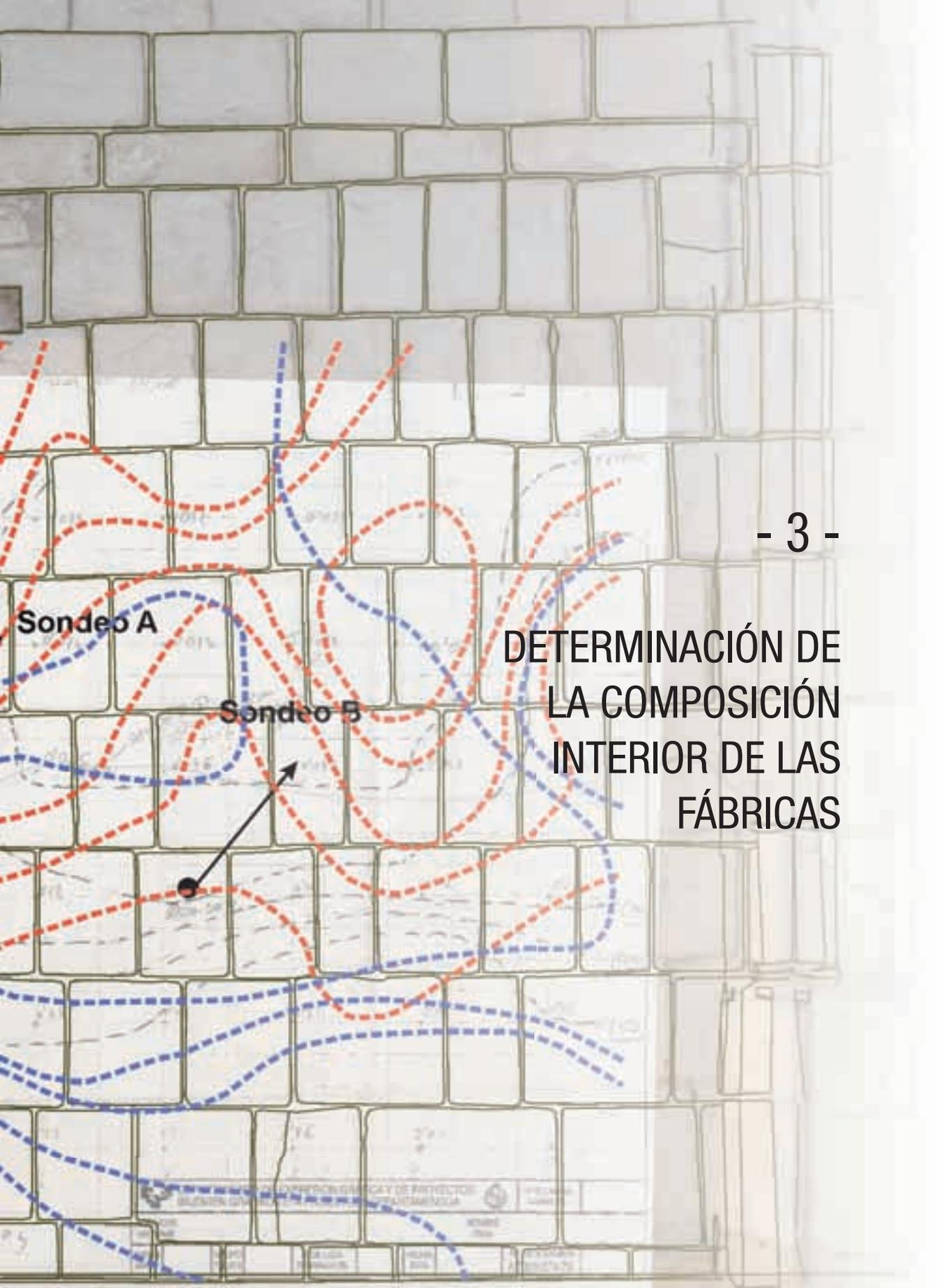
La determinación de la composición interna de un elemento de fábrica se antoja necesaria para evaluar con anterioridad a la inyección, el porcentaje de poros y la comunicabilidad entre ellos. Esto es, resulta conveniente conocer, independientemente del consolidante a inyectar, el volumen previsible de inyección, la posible distribución del mismo, así como el volumen ocupado. Cuestiones a priori difíciles que exigen una metodología de estudios previos exhaustiva y pormenorizada.
