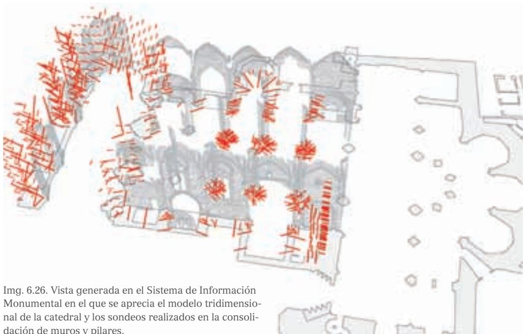
Img. 6.26. Vista generada en el Sistema de Información Monumental en el que se aprecia el modelo tridimensional de la catedral y los sondeos realizados en la consolidación de muros y pilares.
