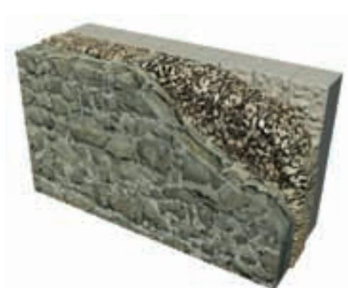
Img. 2.8. Muro con una cara de mampostería, otra de sillería y relleno interior.
