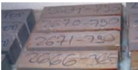
Img. 5.41. Probetas de lechada de cal hidráulica natural NHL-3,5 conservadas en cámara húmeda hasta su rotura a edades de 365 y 730 días.
