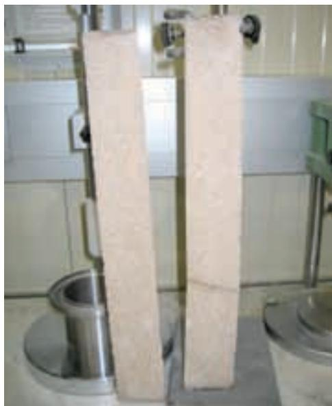
Img. 5.43. Probeta desmoldada y serrada.
