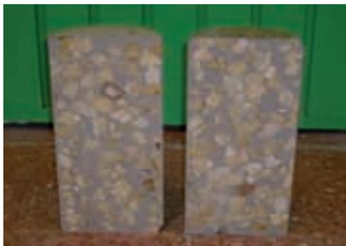
Img. 5.39. Probeta desmoldada y serrada.
