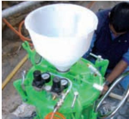
Img. 6.18. Manómetros de control en tapa de calderín.
