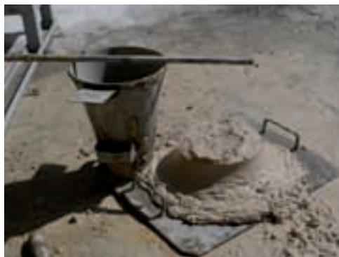
Img. 5.45. Detalle de cono de Abrams realizado al hormigón de cal NHL-3,5.
