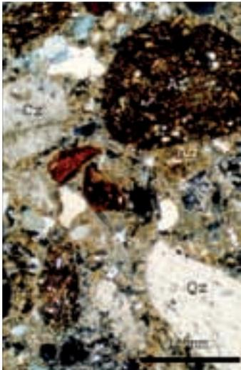
Img. 2.2. Fotomicrografía muestra 1. Cimentación corte calefacción. Absidiolo epístola. Qz: cuarzo; Cz: caliza; Ar: arenisca; Ag: aglomerante.
