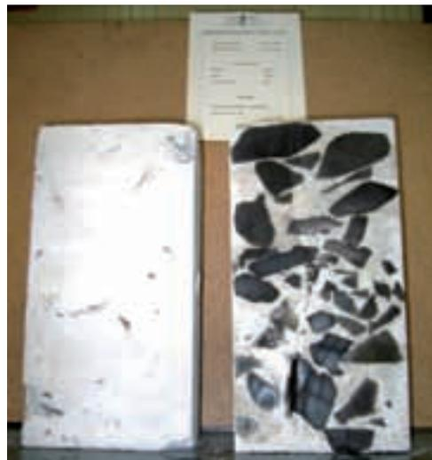
Img. 5.10. Probetas desmoldadas y serradas con árido de cayuelas lavadas.
