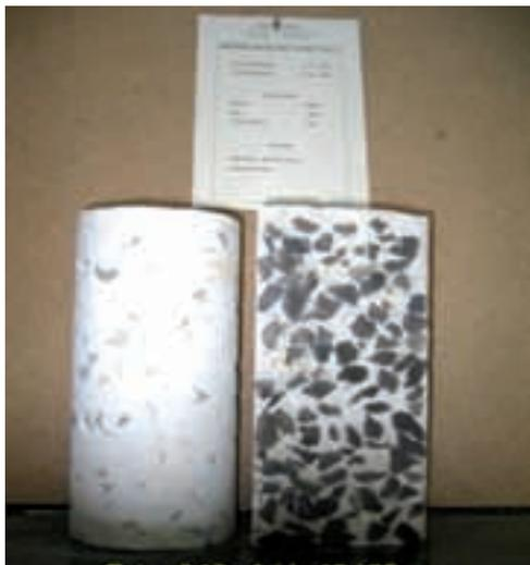
Img. 5.9. Probetas desmoldadas y serradas con árido 18/25 mm.
