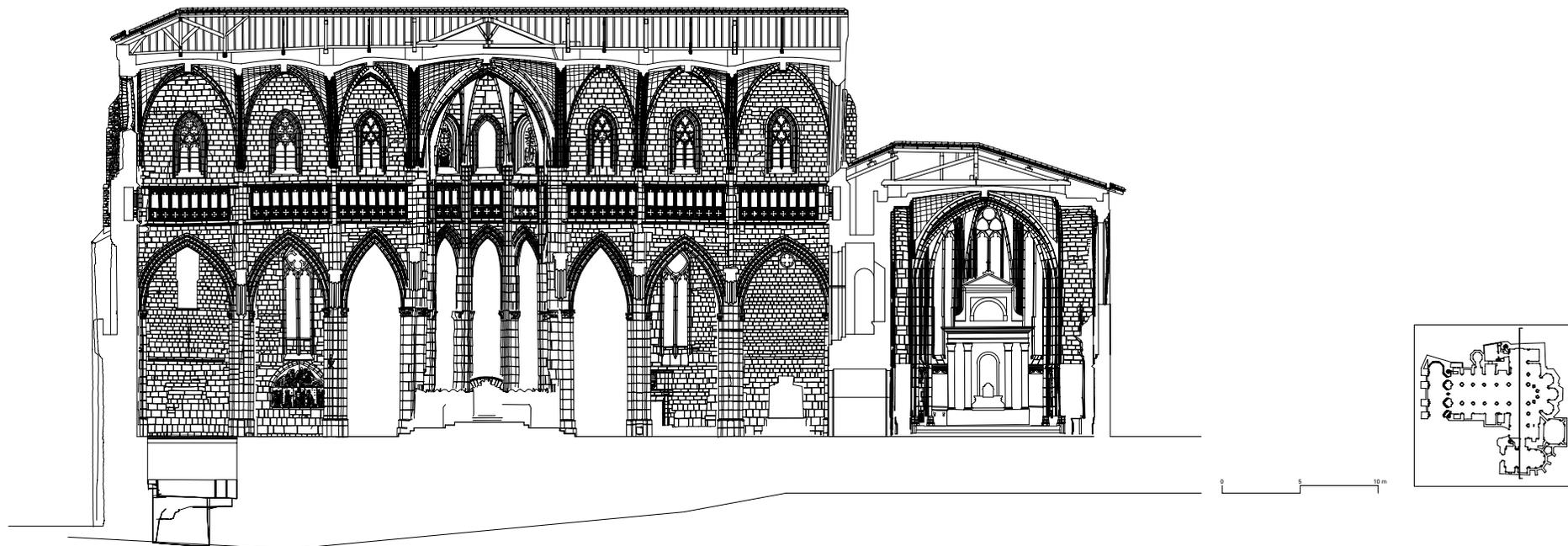
23 Sección transversal nave tramo 4 a este y el alzado oeste crucero. Escala 1:250
