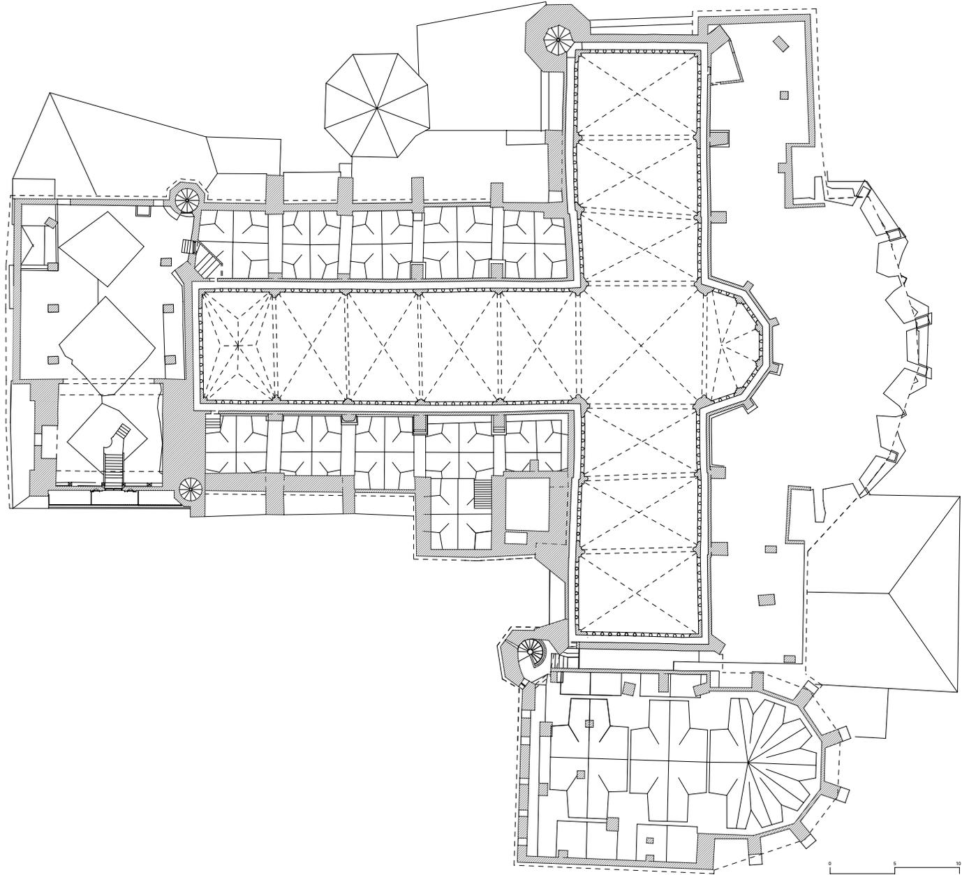
8 Planta de estructura de cubierta de naves laterales, girola y pórtico. Escala 1:250
