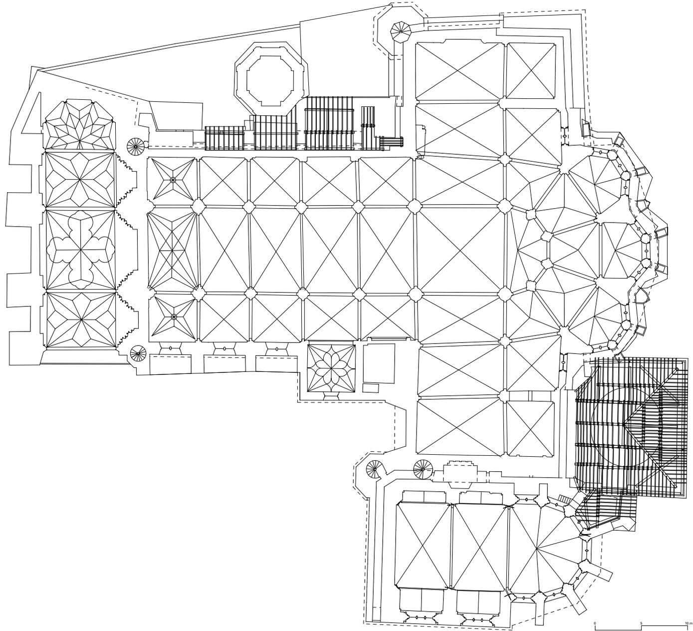
7 Planta del triforio y bajo cubierta de naves laterales, girola y pòrtico. Escala 1:250
