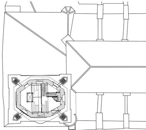
Planta a nivel del reloj. Escala 1:250
