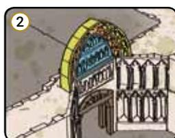
② Ese tímpano servía, en un segundo momento, como base sobre la que ir apoyando las distintas dovelas que conformarían las primeras arquivoltas interiores.
