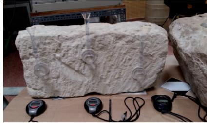
res en zapatas, pilares, contrafuertes, pórtico, muros y fachada, observando medidas de fluidez, resistencia y densidad. Las últimas colaboraciones se han dirigido a la restauración de la Portada de Santa Ana con la inspección de muros y el control de fluidez, resistencia y densidad en la inyección de lechadas de cal, estudio de contenido en sales y ensayos de colorimetría y absorción de agua.
