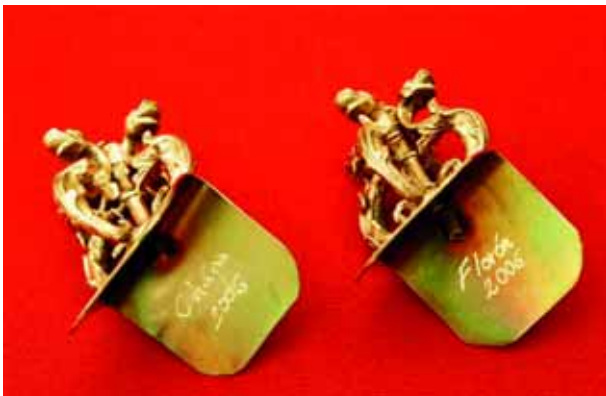
Ejemplo de reproducción de elementos seriados: floron original (izquierda) y floron nuevo (derecha)
